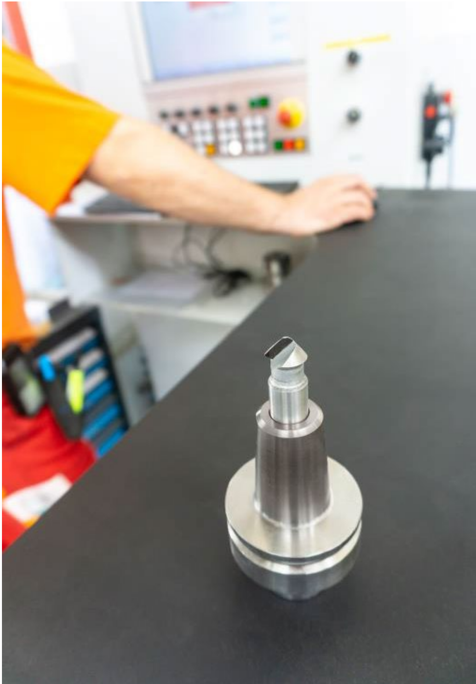
Abb. 2: Der Oberfräser Diamaster PRO ist bei normaler Abstumpfung bis zu dreimal nachschärfbar, womit ein höherer Standweg und eine gesteigerte Wirtschaftlichkeit des Werkzeugs erreicht werden. (Foto: Leitz)
