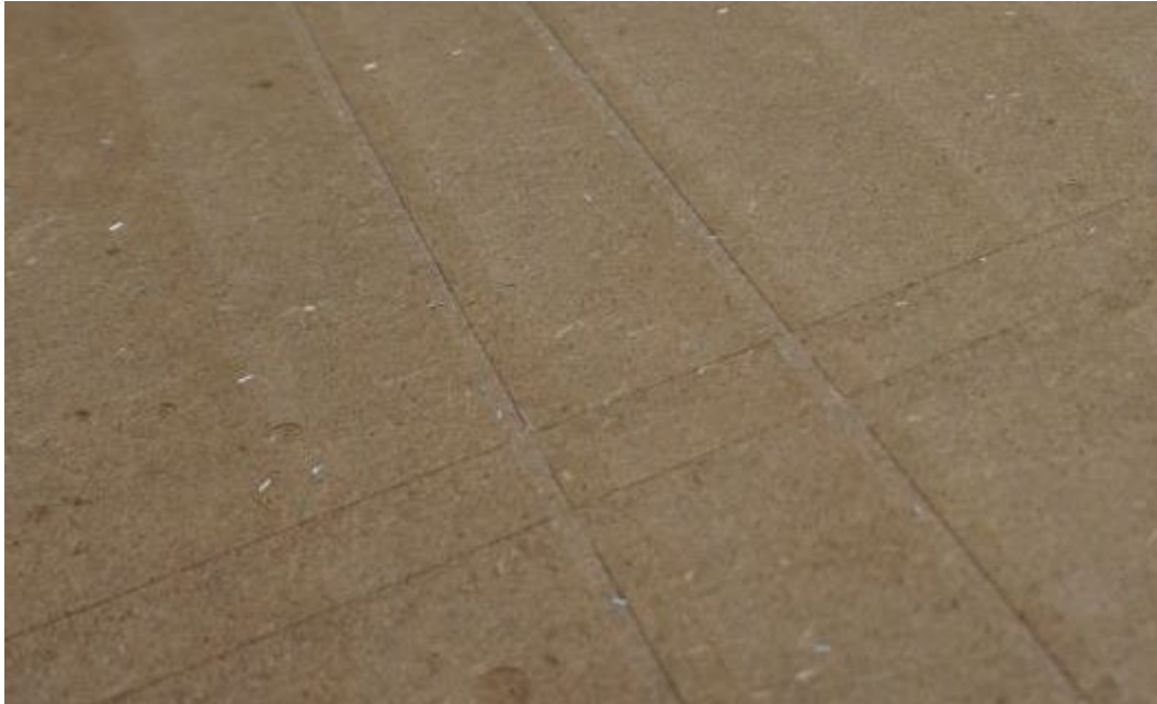
Abb. 3: Die Opferplatte wird beim Sägen der Aluminiumverbundplatten kaum abgenutzt. (Foto: Leitz)
